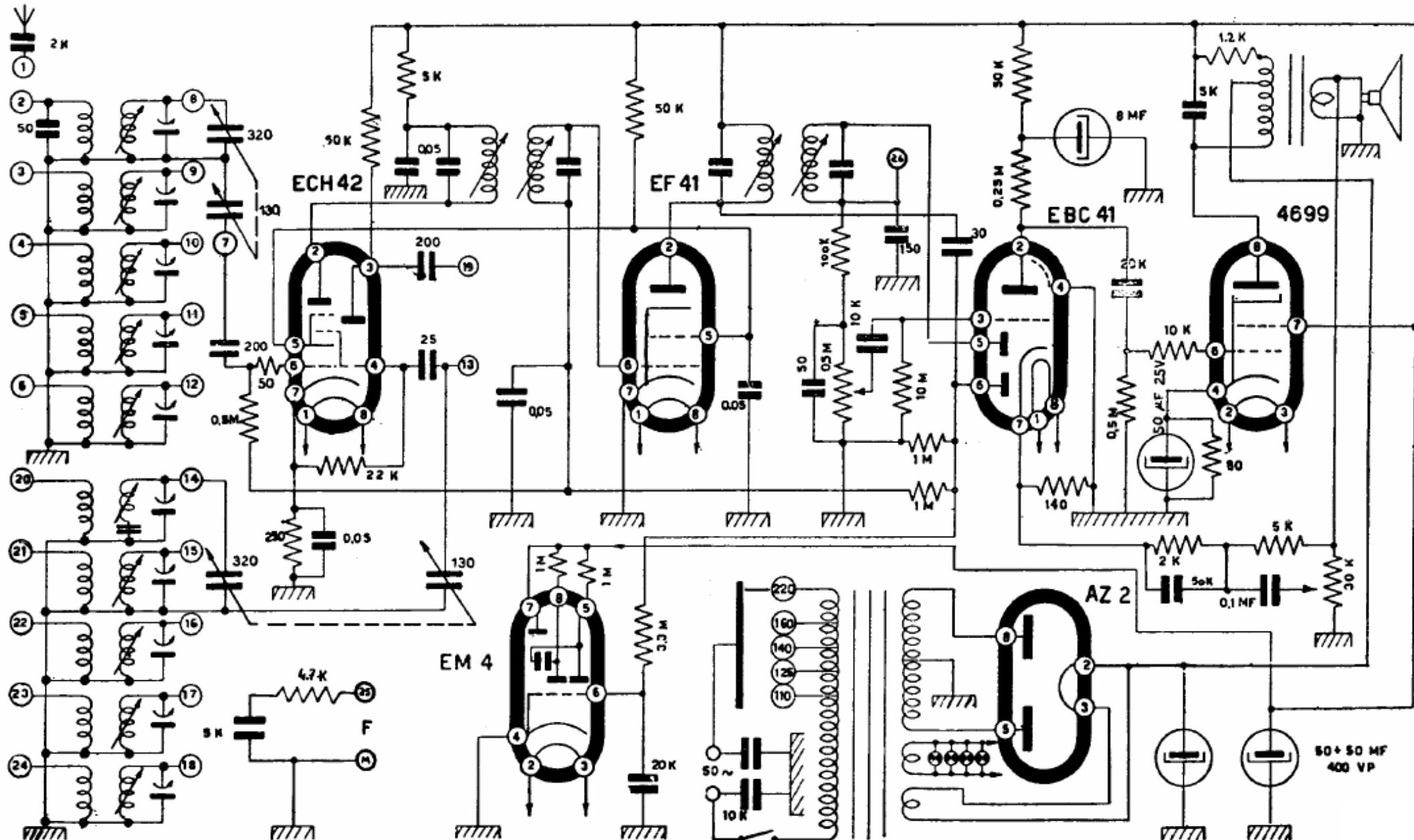
VEGA - Mod. 651. Onde mediche da 520 a 1620 kc/s. Onde costiere da 1680 a 3100 kc/s. Onde tropicali da 3 a 6,2 Mc/s. Onde corte da 5,8 a 11,5 Mc/s, e da 10,5 a 20 Mc/s. Media frequenza 470 kc/s. Potenza indistorta di uscita 5 watt. Consumo 66 watt. Contatti chiusi come mod. 1051.
